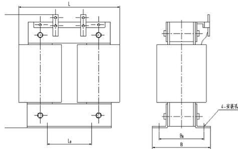
附图4 直流电抗器外形尺寸示意图
