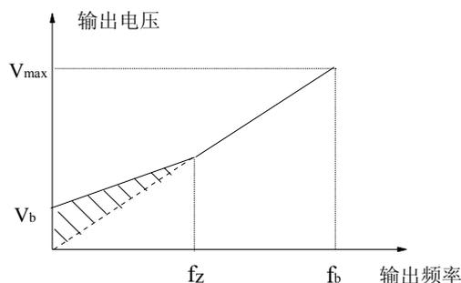
$V_b$ ：手动转矩提升电压     $V_{max}$ ：最大输出电压
