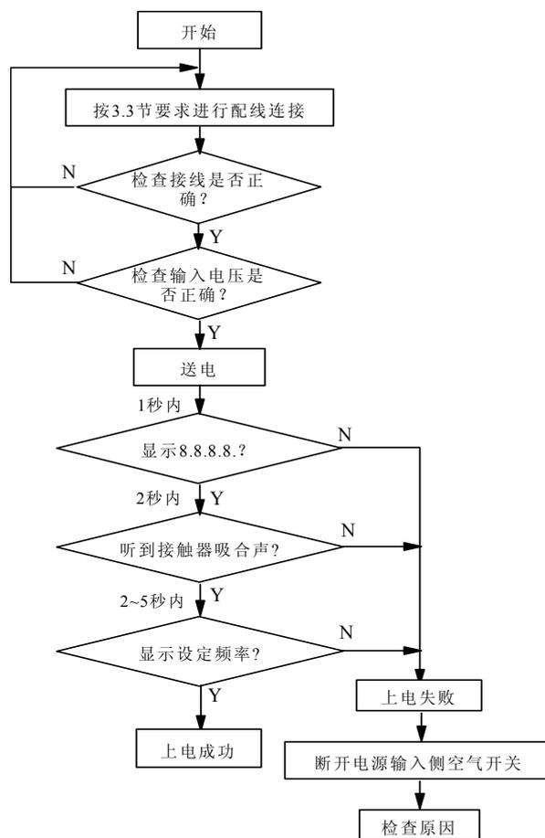
图4-16 变频器初次上电操作流程
