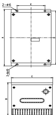
图2-8 制动单元的安装尺寸示意图
