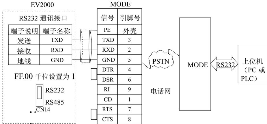
图3-19 RS232- (MODEM-公话网-MODEM) -RS232通讯配线
