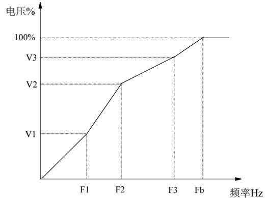
V1~V3: 多段VF第1~3段电压百分比
