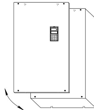
图3-6 钣金盖板的拆卸和安装示意图
