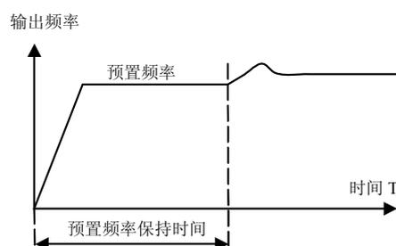
图5-36 闭环预置频率运行示意图
