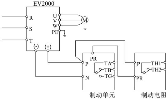
图2-10 变频器与制动组件连线图
