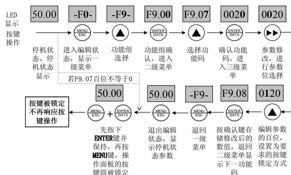
图4-14 操作面板按键锁定的操作示例
