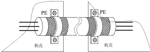
图3-35 正确的屏蔽接地方法
