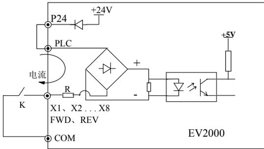
图3-22 使用内部24V电源的连线方式
