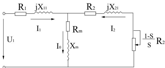
图5-70 异步电机稳态等效电路图
