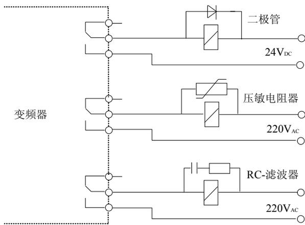
图3-41 继电器、接触器及电磁制动器要求
