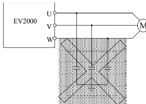
图1-2 变频器输出端禁止使用电容器
