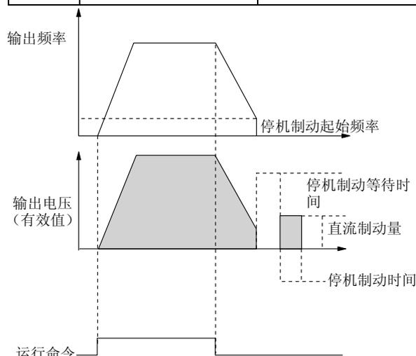
图5-16 减速停车+直流制动示意图
