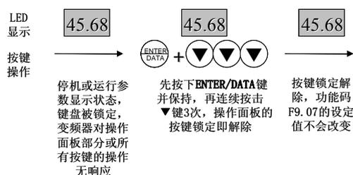
图4-15 操作面板按键解锁的操作示例
