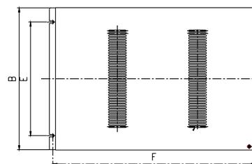
图2-9 制动电阻的安装尺寸示意图
