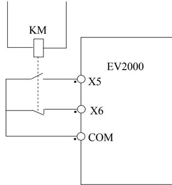
图5-41 外部设备故障常开/常闭输入示意图
