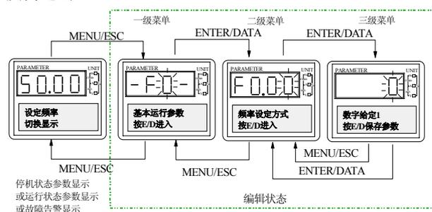
图4-6 操作面板的编程显示状态
