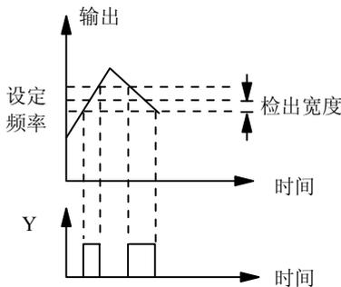
图5-47 频率到达信号输出示意图
