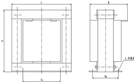
附图3 直流电抗器外形尺寸示意图
