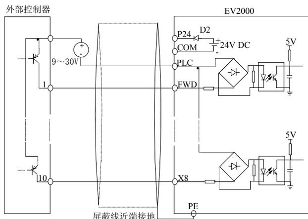
图3-27 使用外部电源的漏极连接方式
