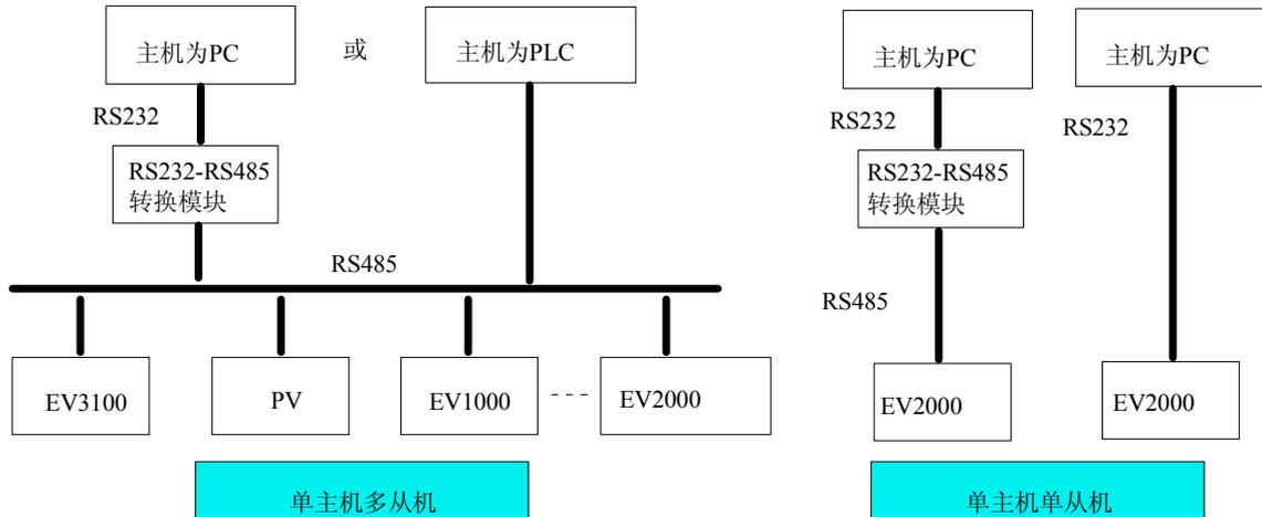
附图6 变频器组网方式示意图
