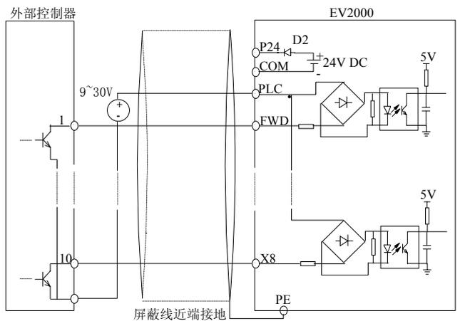
图3-26 使用外部电源的源极连接方式
