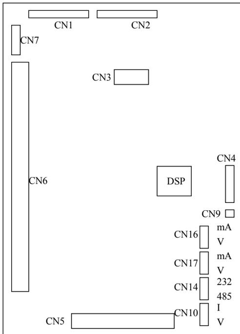
图3-12 控制板的跳线开关位置示意图
