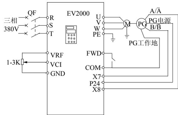
图5-30 PG速度闭环控制系统接线图
