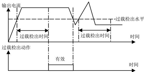
图5-74 过载预报警检出功能示意图
