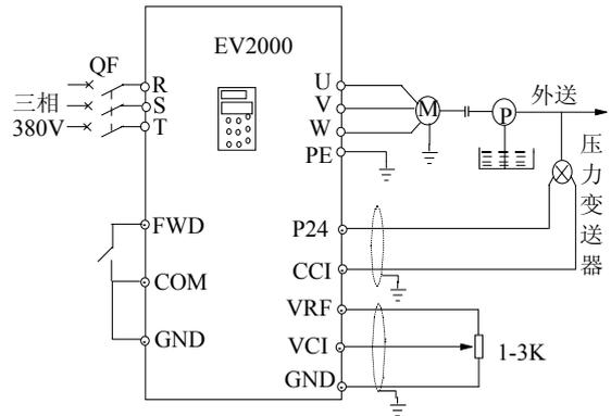
图5-29 内置PI模拟反馈控制系统示意图
