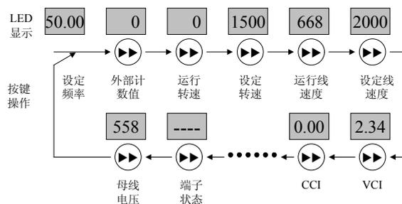
图4-7 停机状态参数显示操作示例
