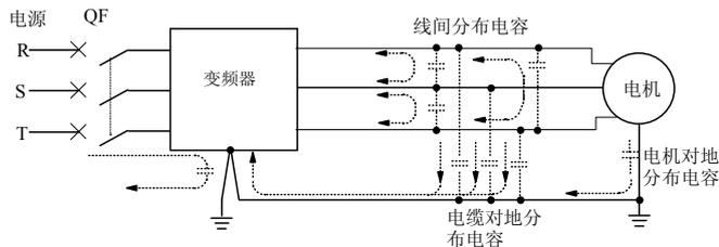
图3-42 漏电路径
