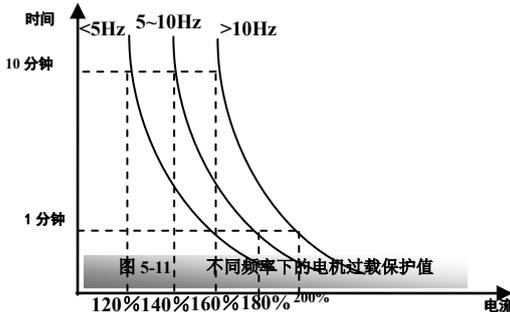
举例说明：使用 7.5KW 的变频器带 5.5KW 电机， $F707 = \frac{5.5}{7.5} \approx 73\%$ （100%≈70%，当电机的实际电流为 140%的变频器额定电流时，1 分钟后变频器跳 7.5
