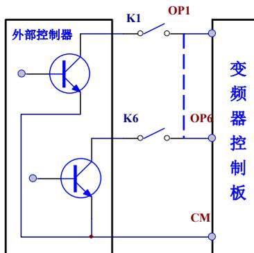
双极性输入控制端子若实现共漏极连接方式，需要将拨动开关 J7 拨到 PNP 位置，单极性输入端子不能实现此种连接方式，具体接线方式如 c、d：
