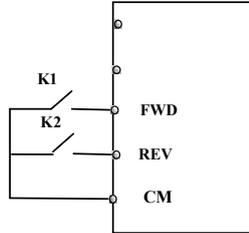
· 2：两线式运转模式 2：应用该模式时，FWD 为使能端子，方向由 REV 的状态来确定。
