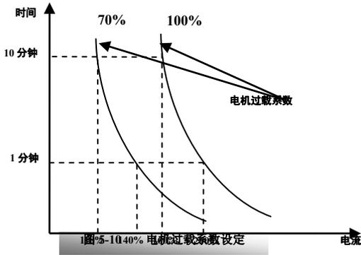
当变频器输出频率小于 10Hz 时，由于普通电机在低速运行时散热效果变差，故在运行频率低于 10Hz 时，电机过载阈值下调，如图 5-11 所示（F707=100%时）：
