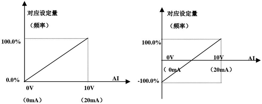
图 5-6 模拟给定与设定量的对应关系
