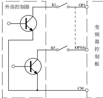
双极性输入控制端子若实现共漏极连接方式，需要将 GP 端子与 CM 端子用短路片短接，单极性输入端子不能实现此种连接方式，具体接线方式如 3、4：
