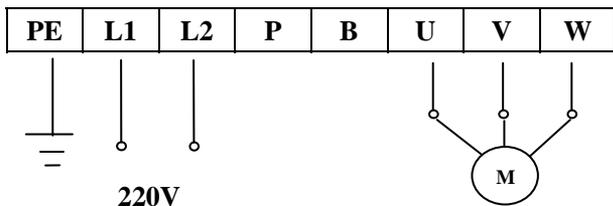
单相 220V 1.5KW~2.2KW 及三相 380V 0.75KW~7.5KW 功率端子示意图
