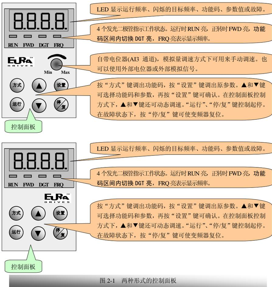
图 2-1 两种形式的控制面板
