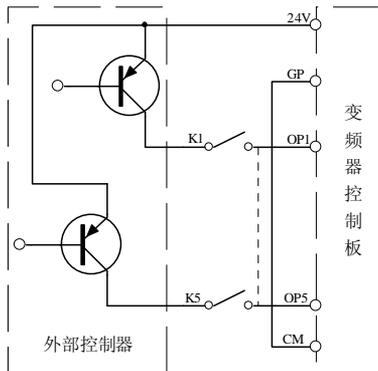
共源极连接方式是目前最为常用的一种方式，双极性输入控制端子出厂值默认为共漏极连接方式，因此用户根据需求进行相应的选择。
