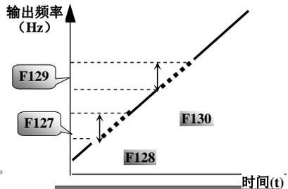
图 5-2 频率回避示意图
